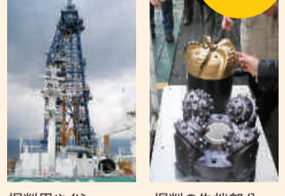
掘削用やぐら 掘削の先端部分
